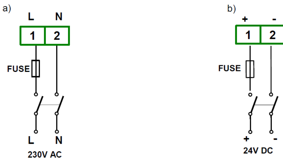
Abb. 4.10 Anschluss von Versorgung a) 230/110 V AC b) 24 V DC
